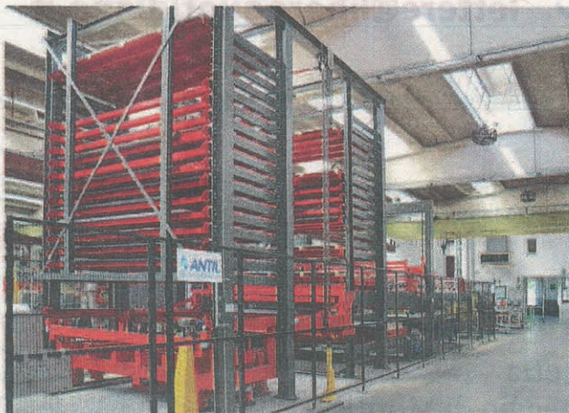
LASER Magazzino a torri multiple del sistema laser Bystronic
